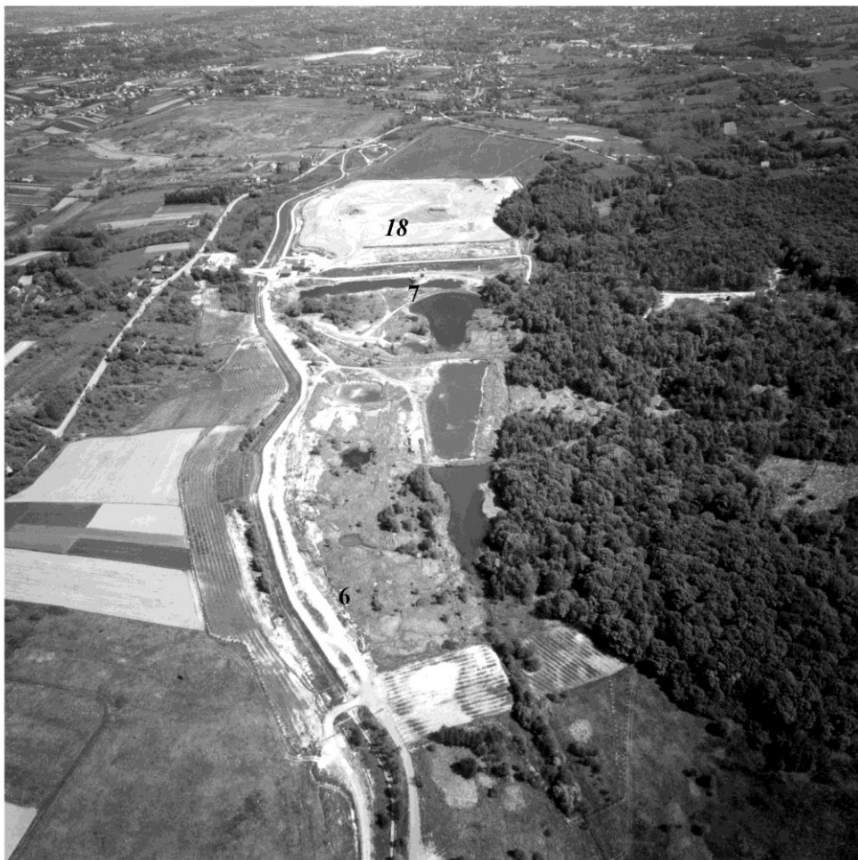
18, 7, 6 - wielkość prognozowanych osiadań końcowych w punkcie wyrażona w metrach (wg Dokumentacji warunków hydrogeologicznych dla "Koncepcji programowo-przestrzennej rozbudowy składowiska odpadów komunalnych Barycz w Krakowie, III etap składowiska")
