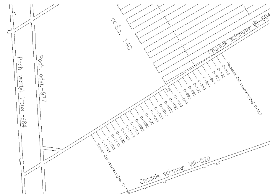
Rys. 6.1. Linia obserwacyjna w chodniku ścianowym VII Fig. 6.1. Observational line in main gate no. VII
