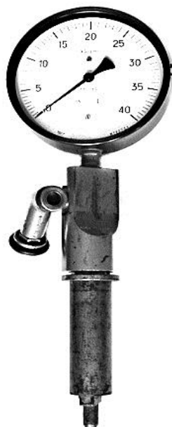
Rys. 3.1. Aparatura służąca do pomiaru ciśnienia gazu w złożu węgla (a – desorbometr cieczowy izobaryczny, b – naczynie sorpcyjne z manometrem) Fig. 3.1. The apparatus the servant to the measurement of the gas pressure in the deposit of the carbon
