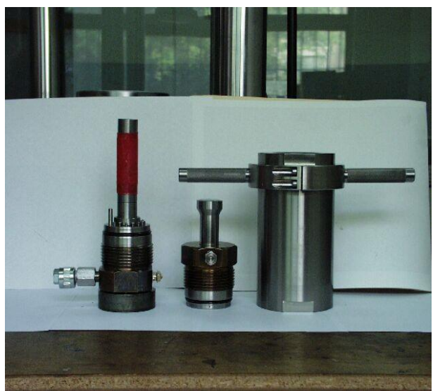
Rys. 3.1. Komora ciśnieniowa typ KTK 70 MPa: a) komora umieszczona w maszynie wytrzymałościowej MTS 810-NEW, b) przygotowanie próbek do badań w komorze Fig. 3.1. Pressure chamber 70 MPa type KTK: a) the chamber located in a stiff testing machine MTS 810-NEW, b) preparation of samples to tests in a chamber
