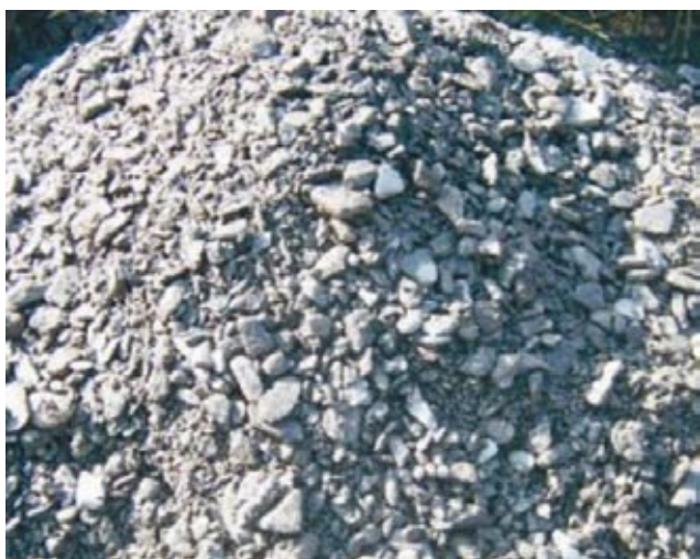
Rys. 7.7. Kruszywo skalne/kruszywo PKW odmiana 1 o frakcji 0-30 mm produkowane w ZG „Sobieski”
