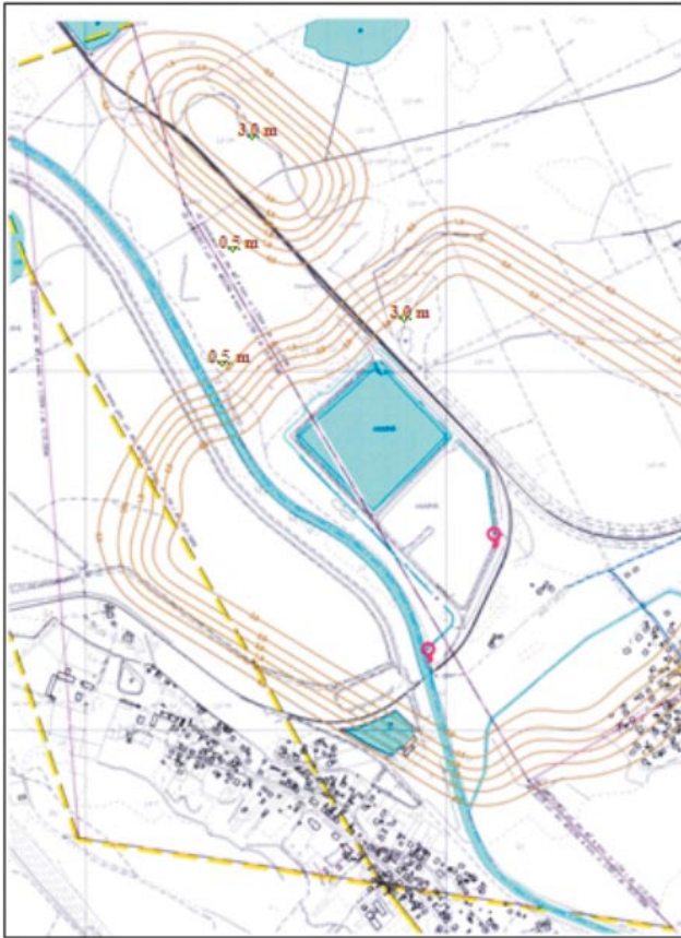
Rys. 3. Wycinek mapy powierzchni z zaznaczonym rozkładem prognozowanych obniżzeń powierzchni terenu po zakończeniu eksploatacji w pokładach 302 i 304/2
