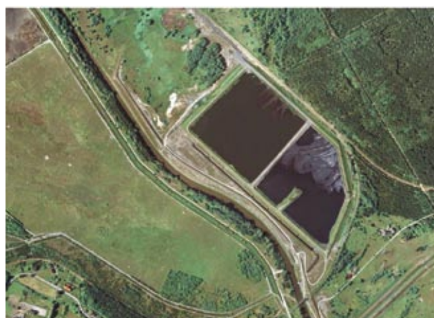
Rys. 7. Osadnik wód dołowych „Biały Brzeg” oraz rzeka Przemsza - widok z lotu ptaka
