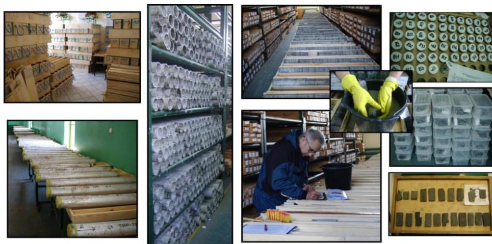
Fot. 5.3. Przygotowanie rdzeni i próbek okruchowych do profilowania i poboru prób Phot. 5.3. Preparation of cores and cuttings samples for profiling and sampling
