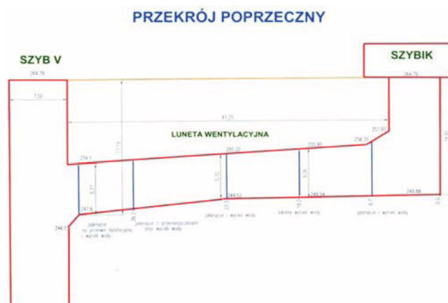
Rys. 1.3. Miejsca pęknięć i uszkodzeń obudowy lunety wentylacyjnej szybu V Fig. 1.3. Points of shakes and damages of underground fan-drift's lining of shaft no. V
