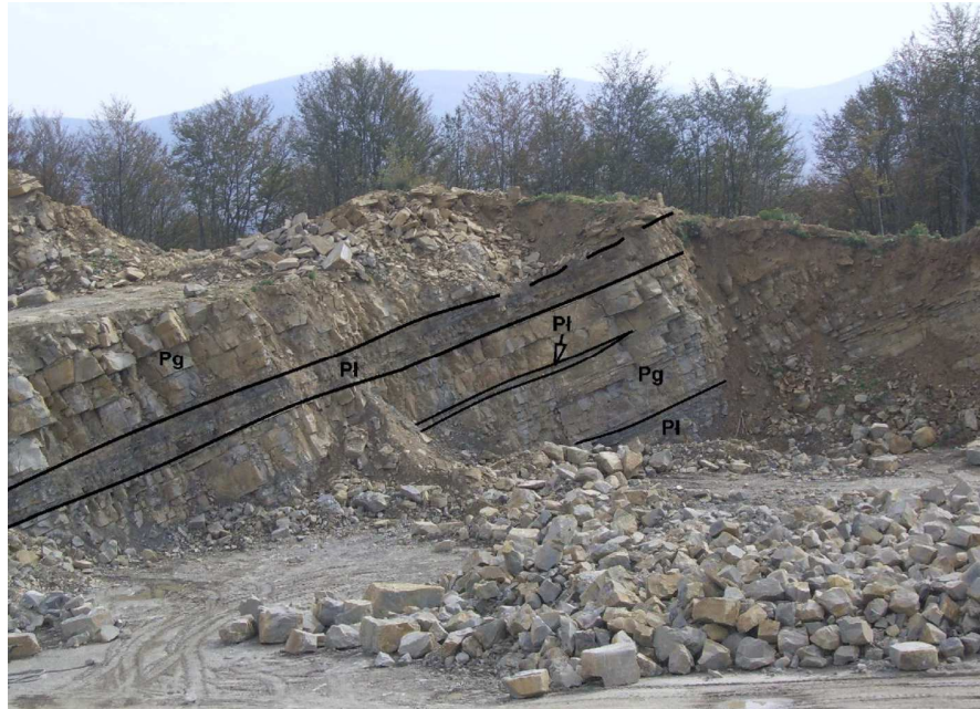
Rys. 6.1. Kamieniołom „Lipowica II-1”. Piaskowce gruboławicowe (Pg) i piaskowce poprzelawicane łupkami (Pl) (fot. E. Kusaj)
